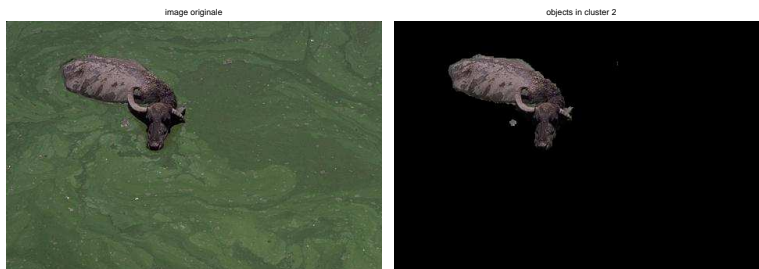
FIGURE 2 – Exemple de segmentation d'image couleurs en deux classes par l'algorithme des K -means
